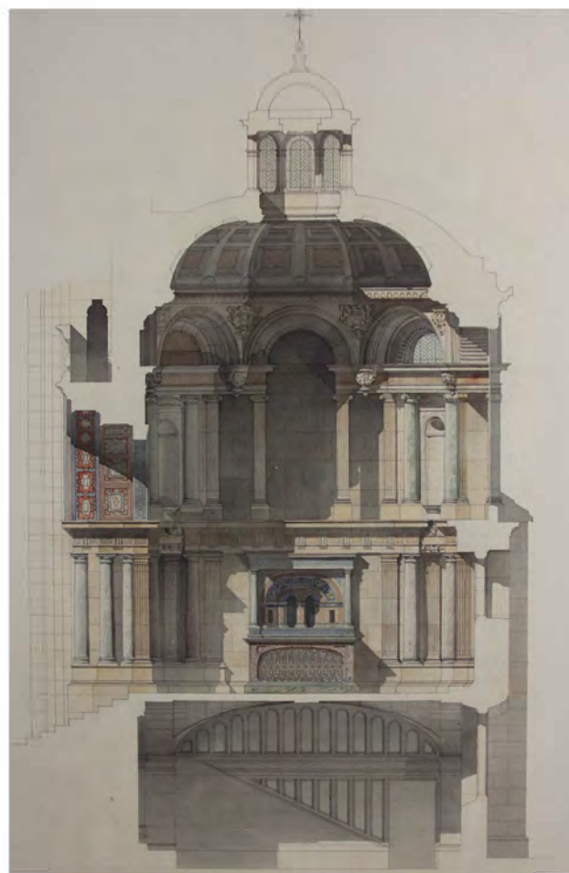
18. Comparaison de la lanterne relevée par P. Boeswillwald et de la coupole reconstruite, relevé 2024. Archiv'MH Inventaires de la MPP, 081-54-285-1-9, n° 7823 / C. Klosterkötter relevé 2024
