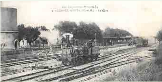
Barisey-la-Côte, une locomotive de type Crapaud 021, qui fut en service jusque vers 1922.
