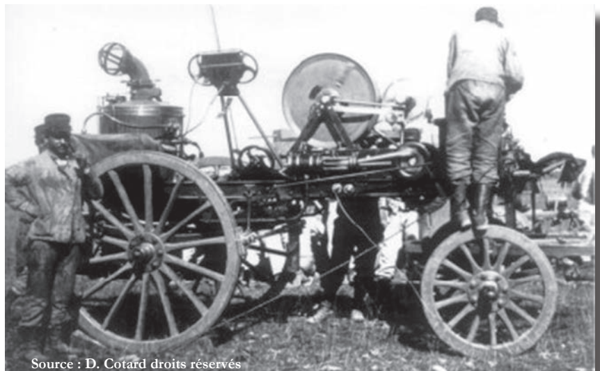
Chaudière, treuil sur un châssis hippomobile.
