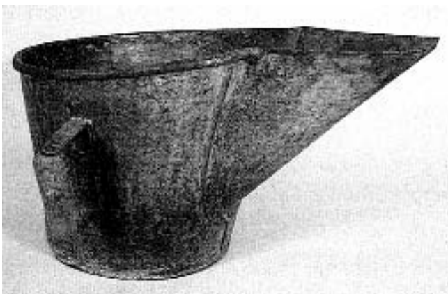
Seau à prélever les restes de cire afin de couler des lingots
