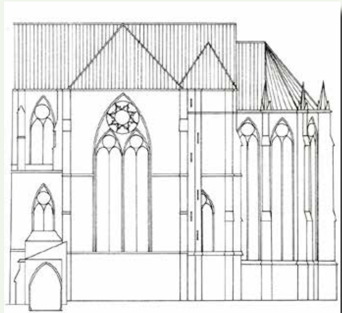
25. Élévation schématique sud de la cathédrale gothique de Toul, à l'issue de la deuxième campagne de travaux (A. Villes, del.).
