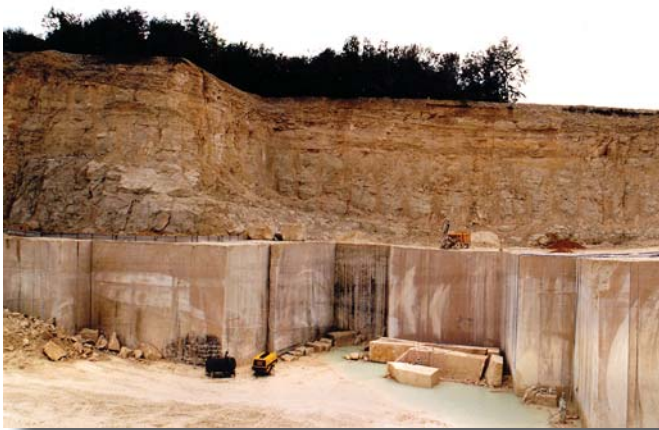
Le front de taille pour des découpes par fil, l'entamure se fait à l'explosif.
