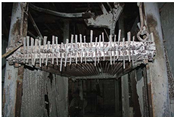
Une vieille scie à cadres encore dans sa position de travail.
