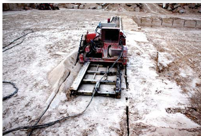
La haveuse sur rail découpe les blocs sous le lit de fond.
